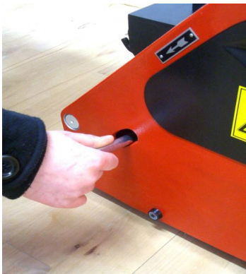
Wechsel der Bürstwalze - Achtung: Linksgewinde!
